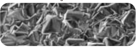
結晶粒度4μm (以上) Crystal Size 4 μm (minimum)
