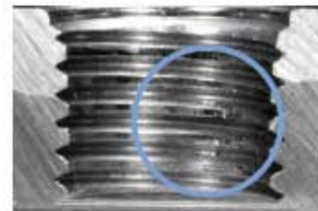
スパッタ除去 (ゲージ GP:OK) Spatter removal (Gage GP:OK)
