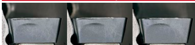
PHC 900m 加工時の写真 After 900 of milling
